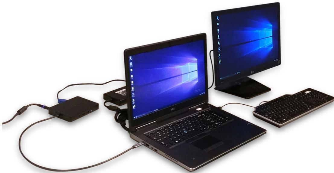
**NOTA:** Los equipos que requieran más de 130 W de entrada de alimentación también deben conectarse a sus propios adaptador de alimentación para la carga y el funcionamiento al máximo rendimiento.
